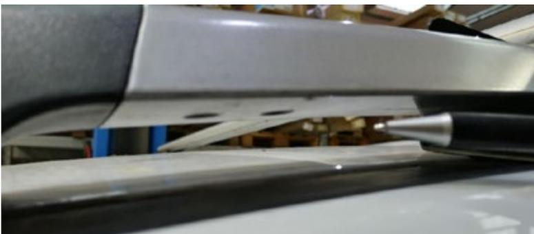
Entfernen Sie beide Inbusschrauben aus den original Dachträgern.
