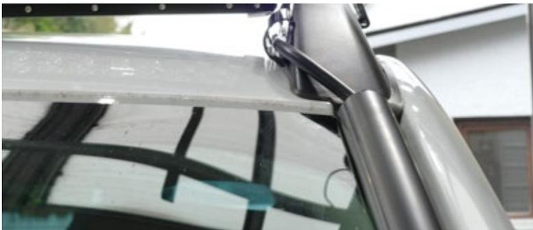
Kleben Sie den beiliegenden Kabelkanal auf die Frontscheibe. Ziehen Sie anschließend das Kabel durch den Kanal in richtung Motorhaube.
