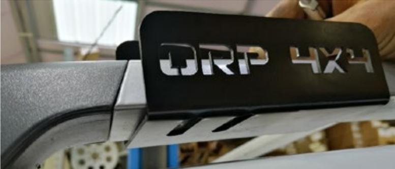
Schieben Sie die Halterlasche, wie auf der Abbildung zu sehen, an die richtige Stelle und schrauben Sie diese mit den beiliegenden M6 Schrauben fest.
