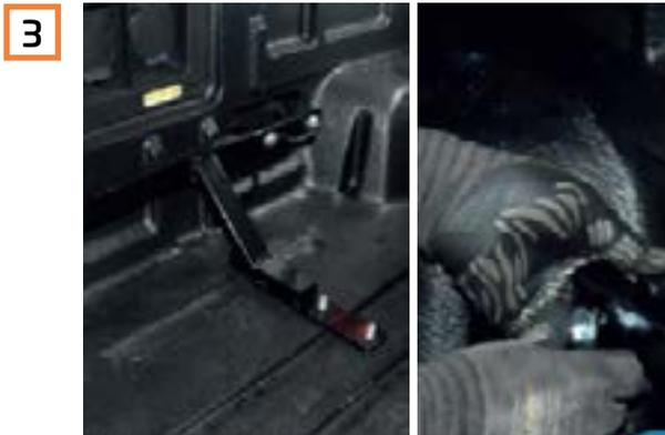
Platzieren Sie die Stütze **a** (2x) in Höhe der vorderen Zurrösen.
