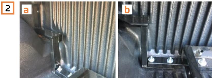
Im vorderen Bereich werden die zwei Halterungen (siehe Abbildung a und b) mit den beiliegenden M8x30 Schrauben links und rechts montiert.
