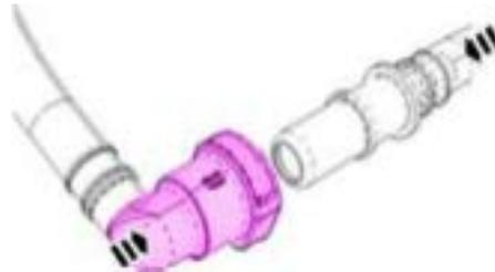
Die Kappen vom Kraftstoff-Entlüftungsschlauch entfernen. Den Kraftstoff-Entlüftungsschlauch wieder am Winkelstecker anschließen. Sicherstellen, dass der Schlauch angeschlossen und der Clip vollständig eingerastet ist (nur rechte Seite).
