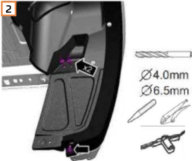
Die untere Schraube ausbauen und die Niete vorsichtig auf beiden Seiten von der Hinterradhausschale entfernen.
