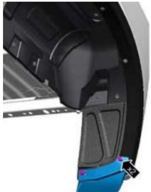
1. Die aerodynamische Lippe auf beiden Seiten entfernen (falls eingebaut). Die Nieten entsorgen.
