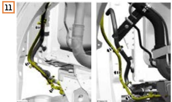
11 Ggf. den Kabelstrang vom Kraftstoff-Entlüftungsschlauch ausclipsen (nur linke Seite).
