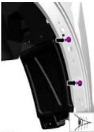
Die Zierleiste - Radhauslippe vorsichtig zurückziehen, um zu den Schrauben der unteren hinteren Zierleiste -Radhaus (2 Stück) zu gelangen. Die Schrauben und den Eindrückstift entfernen. Die untere hintere Zierleiste vom Fahrzeug lösen.
