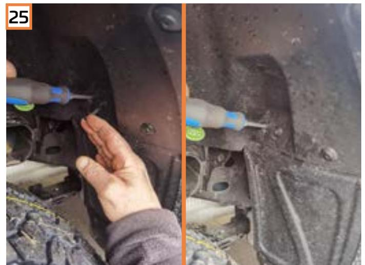
Die Radhausverkleidung und die Spritzschutzvorrichtungen einbauen. Positionieren Sie dabei den Spritzschutz mit Hilfe eines Schraubenziehers. Tauschen Sie die Nieten mit dem mitgelieferten Clip F aus. Die untere Schraube wieder einbauen.
