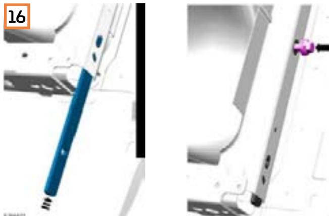
16 Die Gewindeplatte in die Öffnung stecken und die Schraube des oberen Halters M10x30 handfest eindrehen (damit die Gewindeplatte fixiert ist). Die obere Schraube NOCH NICHT festziehen.
