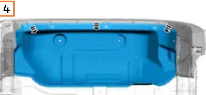
Die äußere Lippe der Radhausverkleidung unter der Zierleiste - Radhauslippe herausschieben, indem sie in Richtung Fahrzeugmitte geschoben wird. Dabei darauf achten, dass die Radlippenverkleidung nicht beschädigt wird.
