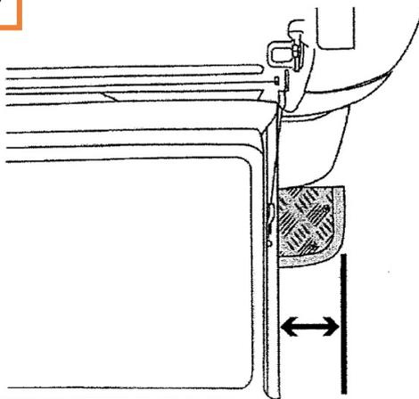
Einsatzposition - Stellen Sie sicher, dass die Seitenwinkelbewegung ausreichend, um auch bei abgesenkter Heckklappe, Zugang zur Stufe zu erhalten.
