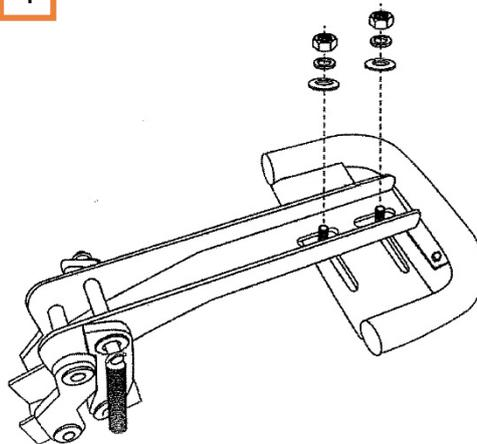
Befestigen Sie die Trittstufe am Verbindungssatz wie
