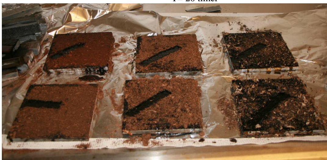
Figur 6; Steinplater med olje og absorbent ved ulike virketid med tung bunkersolje IFO380. Absorbentene er hhv øverst fra venstre mot høyre; Barkprodukt – Kallak torv tørket Kallak torv/spon tørket – Torvprodukt – Kallak torv fuktig – Kallak Torv/spon fuktet
