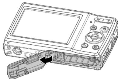
3. 将电池插入电池槽，电池端子朝内，正确方向如图所示。
