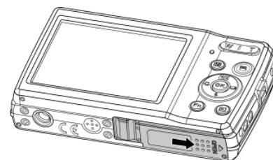
2. 解锁并打开相机底部的电池/存储卡槽。
