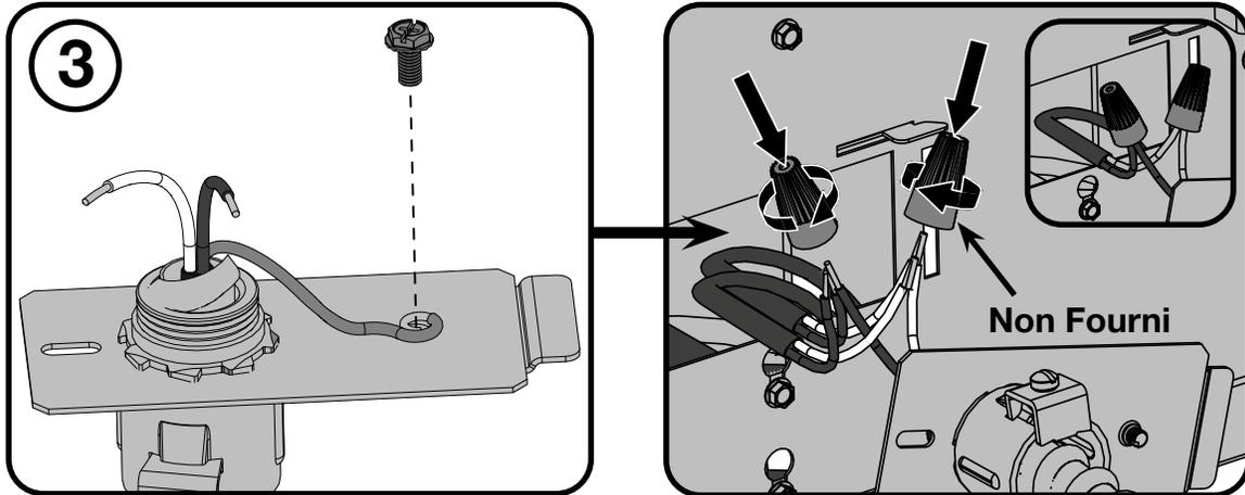
4. Réinstallez la plaque de recouvrement à l'aide de la vis (N570-0008), comme illustré.
