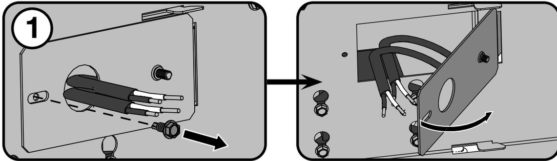
2. Installez le connecteur du boîtier dans le trou de 7/8 "(22,2 mm) et dans la plaque de jonction.
