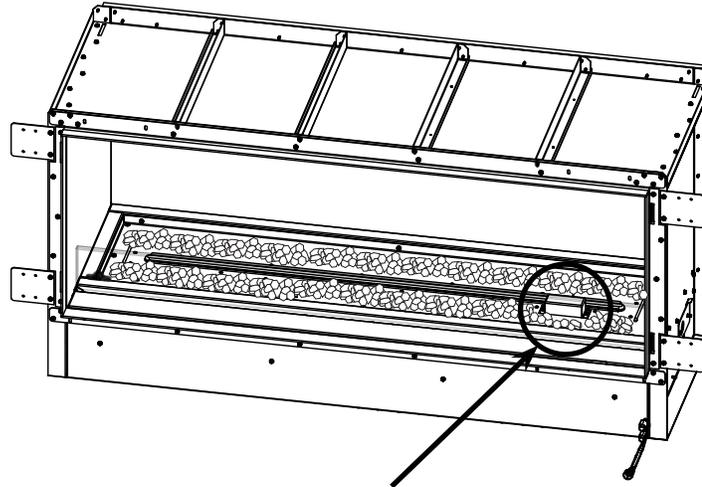
**ENSURE NO GLASS IS PLACED ON THE IGNITION PORTION OF THE BURNER, DIFFICULTIES IN LIGHTING MAY RESULT.**
