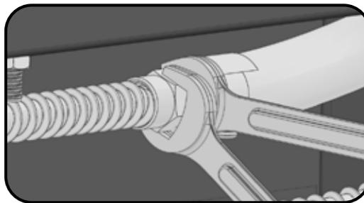
**Réinstallation:** Inversez la procédure pour réinstaller le brûleur. Vérifiez que l'orifice pénètre dans le brûleur lors de l'installation. Remplacez les braises de verre et l'écran de verre avant. Lorsque l'appareil est remis en service, comparez le modèle de flamme du brûleur aux images de la section «Fonctionnement» pour vérifier que l'appareil fonctionne correctement.
