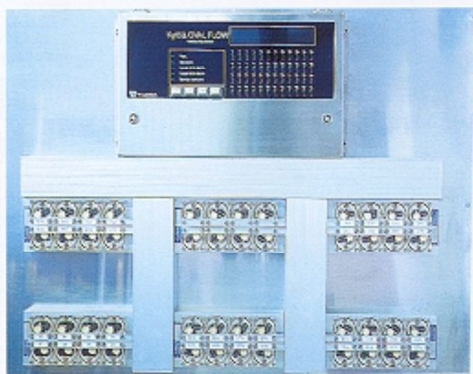
KYTÖLÄ OVALFLOW ÖVERVAKNINGSSYSTEM FÖR CENTRALSMÖRJNING PÅ PAPPERSMASKINER
