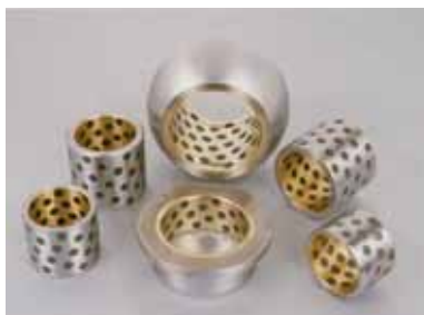
JDB-3 Bimetall med fasta smörjmedel Bärighet 70N/mm 2 . Temperaturområde >300°C. Max hastighet 2 m/s
