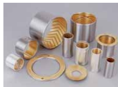
JF-800 Bimetall med sintrad glydyta Bärighet 65N/mm 2 . Temperaturområde >260°C. Medium hastighet
