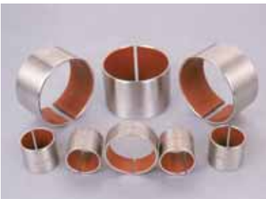
NB1S Ptfе rostfri Bärighet 140N/mm 2 . Temperaturområde -195°C ~ +280°C. Max hastighet 2,5 m/s
