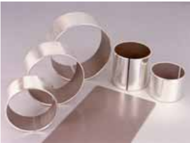
NB1W Ptfе blyfri Bärighet 140N/mm 2 . Temperaturområde -195°C ~ +280°C. Max hastighet 5 m/s
