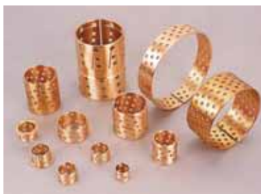
FB092 Homogen brons Bärighet 60N/mm 2 . Temperaturområde -100°C ~ +200°C. Max hastighet 2,5 m/s
