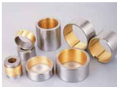
UF-850 Stål med sinterbrons Bärighet 65N/mm 2 . Temperaturområde >260°C. Låg hastighet
