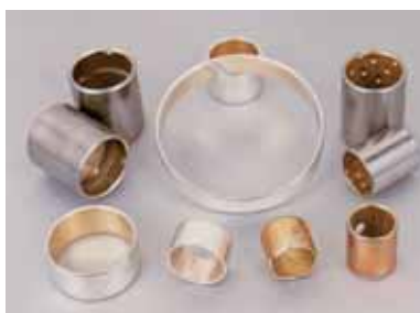
JF-720 Bimetall med sintrad glydyta Bärighet 38N/mm 2 . Temperaturområde >170°C. Hög hastighet
