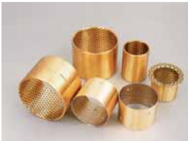
FB090G Homogen brons med fast smörjmedel. Bärighet 65N/mm 2 . Temperaturområde -100°C ~ +260°C Max hastighet 4 m/s
