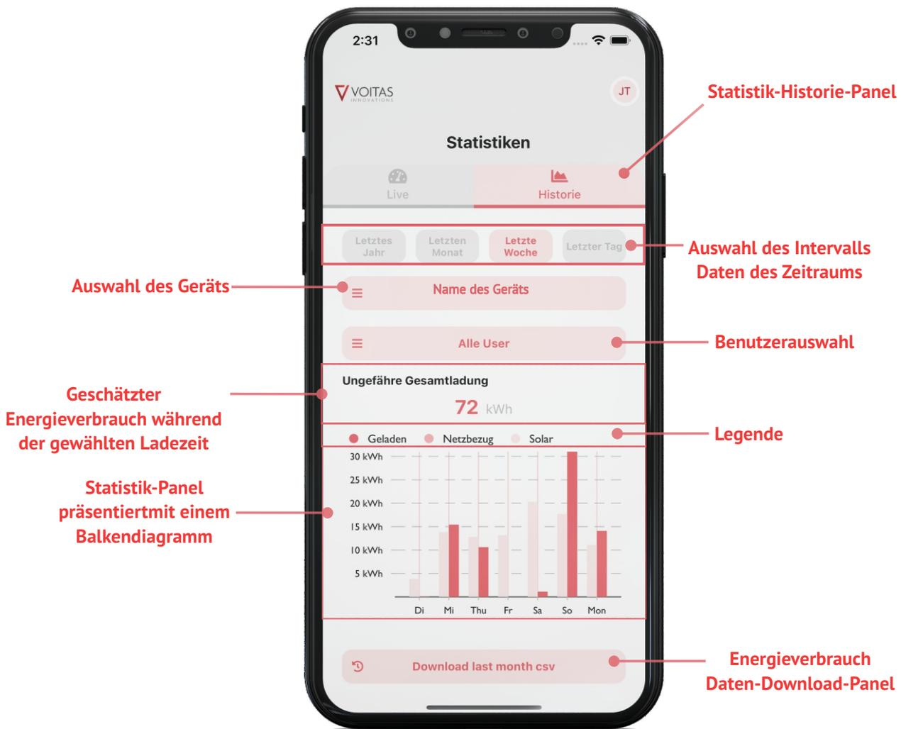
Energiestatistik des VOITAS Smart Meters - Informationen über die von Solarmodulen erzeugte Energie, überschüssige Energie und deren Verwendung im Ladeprozess.
