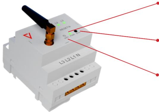
**Schritt 1.** Sobald der Strom angeschlossen ist, zeigt die **LED PWR** an, dass das Gerät eingeschaltet ist.
