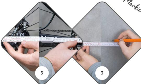
3. Miss die Länge von der Narbe des Vorderrads bis zu der des Hinterrads. Dies ist der Abstand vom ersten zum zweiten Reifen-Halter. Übertrage den Abstand, gemessen vom ersten Kreuz, an deine Wand und mach ein zweites Kreuz. Achte darauf, dass beide Kreuze die gleiche Höhe haben. Nutze die Bohrschablone und markiere nun auch hier die roten Bohrlöcher wie oben beschrieben.
