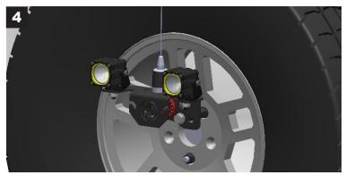
REINSTALL THE BRACKET AND TIGHTEN ALL FASTENERS.
