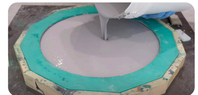
Step Six Pour remaining mixture into mould.
