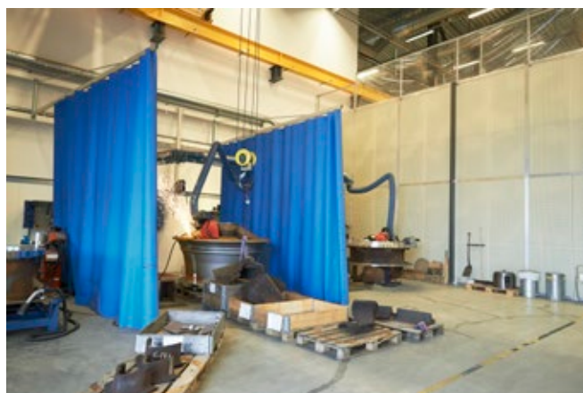
Draperierna håller inte bara buller borta utan skyddar även mot slipdamm, gnistor och splitter (från ex. sprucken slipskiva). En viktig aspekt då båsen ligger sida vid sida.
