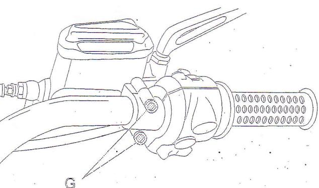
⑦ Den Heizgriff rechts (6) einsetzen und die zuvor aus dem Gehäuse entfernten Gaskabel wieder anschließen.
