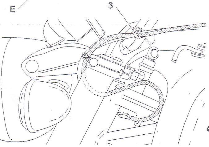
**●** Togliere i due passacavi (D) dal manubrio e sostituirli con i nuovi passacavi (3) in dotazione nel kit. Aprire il passacavo in gomma (E).
