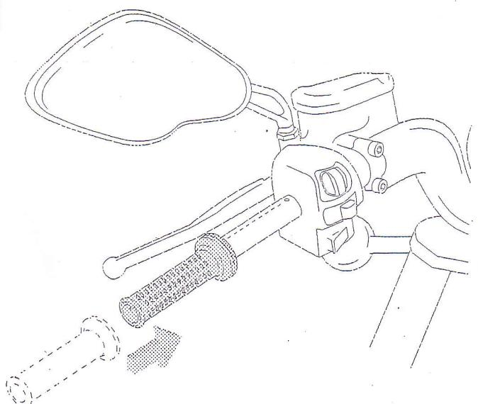
④ Soulever le revêtement en caoutchouc et les deux vis autotaraudeuses (2) situées sur la poignée chauffante (1).
