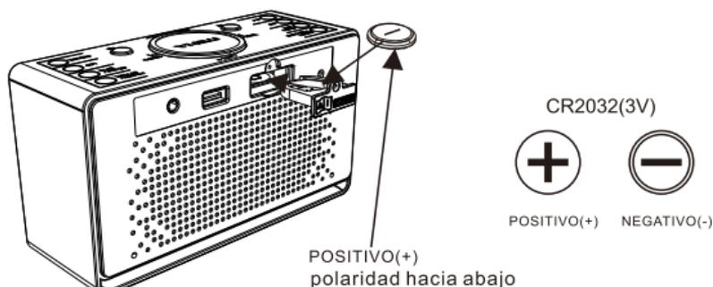
La batería de respaldo de litio debe reemplazarse cuando el indicador de **BATERÍA BAJA** parpadea; de lo contrario, la configuración de la hora y la alarma se perderá / restablecerá después de un corte de energía.
