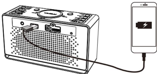
**Nota:** La energía eléctrica extraída del puerto USB puede variar debido a las diferentes condiciones del cable de carga, las características de la batería o el sistema de administración de energía del dispositivo que se está cargando.
