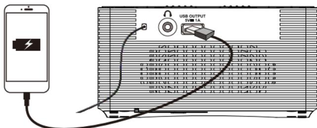
5 V-Ausgang mit bis zu 1A zum Aufladen von Mobiltelefonen oder tragbaren digitalen Audiogeräten.
