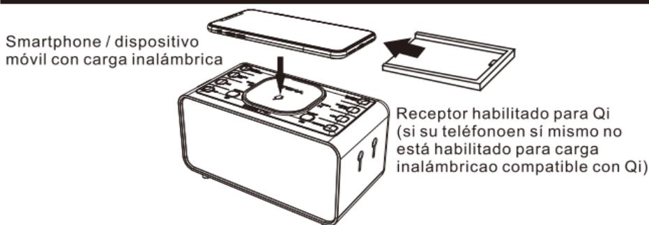
Se construye una plataforma de carga inalámbrica ultrarrápida en la parte superior de esta unidad para la transferencia de energía inalámbrica a cualquier teléfono inteligente compatible con Qi o receptor habilitado para Qi en una distancia vertical de no más de 0,2 pulgadas (5 mm)
