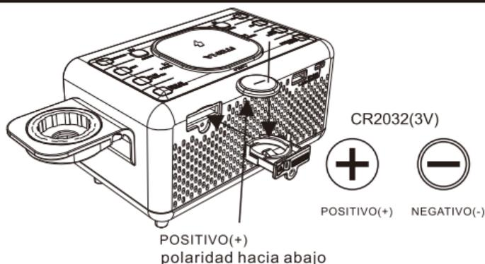
La batería de respaldo de litio debe reemplazarse cuando el indicador de **BATERÍA BAJA** parpadea; de lo contrario, la configuración de la hora y la alarma se perderá / restablecerá después de un corte de energía.
