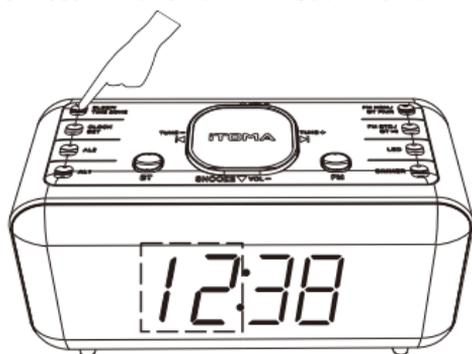
①「**TIME ZONE**」ボタンを長押しすると、HOURの桁が点滅します。
