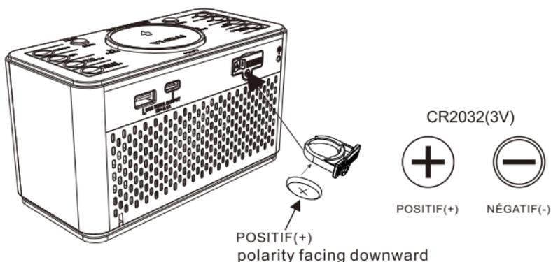
English La batterie de secours au lithium doit être remplacée lorsque le témoin **LOW BATTERY** clignote, sinon les réglages de l'heure et de l'alarme seront perdus / réinitialisés après une panne de courant.
