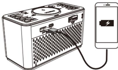
**Nota:** La energía eléctrica extraída del puerto USB puede variar debido a las diferentes condiciones del cable de carga, las características de la batería o el sistema de administración de energía del dispositivo que se está cargando.
