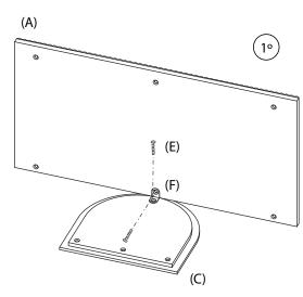
Coloque la pletina en L de metal (F) para fijar la tapa inferior (C) al panel flexible (A). Coloque los tornillos (E) pero no los apriete todavía.
