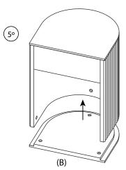
Dé la vuelta al producto para colocar fácilmente la tapa superior (B).
