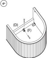
Atornille una pletina en L de metal (F) a la pieza de madera (D) para terminar de sujetar todas las piezas.
