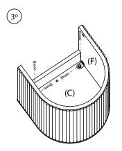
Coloque dos pletinas en L de metal (F) para sujetar la tapa inferior (C) en su lugar.
