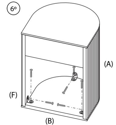
6° Finalement, visser trois pièces métalliques en forme de L (F) au couvercle supérieur (B) et au panneau flexible (A).
