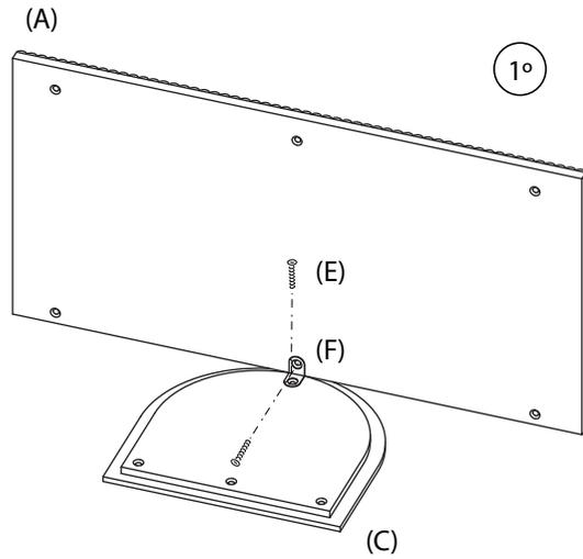
1° Placer la pièce métallique en L (F) pour fixer le couvercle inférieur (C) au panneau flexible (A). Placez les vis (E) mais ne les serrez pas encore.
