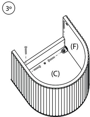
3° Placer deux pièces métalliques en forme de L (F) pour maintenir le couvercle inférieur (C) en place.
