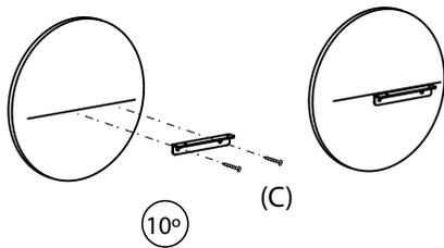
Atornille la pletina en L metálica usando la línea marcada
