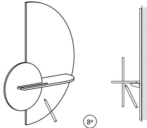
Haga una línea en la intersección de la pieza pequeña de madera por la parte trasera
