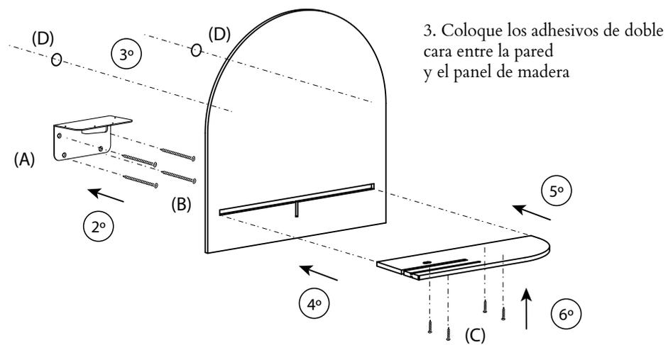
3. Coloque los adhesivos de doble cara entre la pared y el panel de madera
