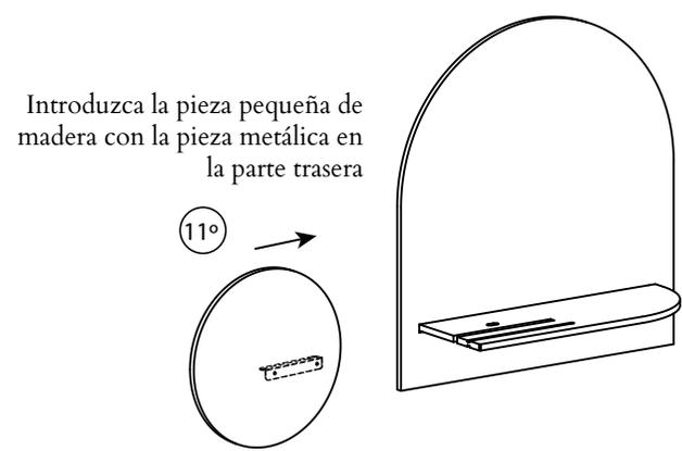
Introduzca la pieza pequeña de madera con la pieza metálica en la parte trasera
