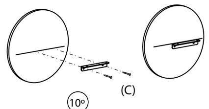
Atornille la pletina en L metálica usando la línea marcada
