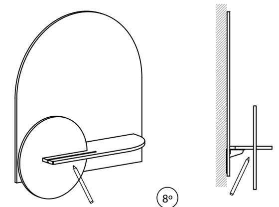
Haga una línea en la intersección de la pieza pequeña de madera por la parte trasera
