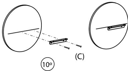
Schrauben Sie das L-förmige Metallstück an der markierten Linie fest.
