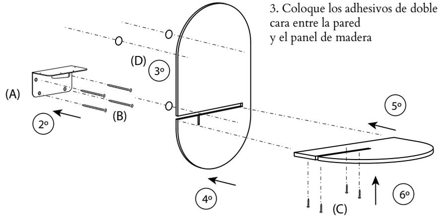
3. Coloque los adhesivos de doble cara entre la pared y el panel de madera
