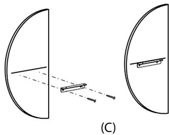
Atornille la pletina en L metálica usando la línea marcada
