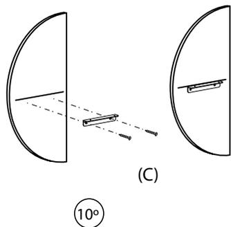
Schrauben Sie das L-förmige Metallstück an der markierten Linie fest.
