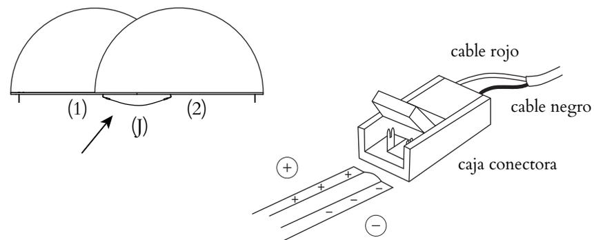
3 Habrá recibido un cable de conexión premontado (K+L+M) que le permitirá conectar los LED a la toma de corriente. Conecte el extremo de la tira de LED del panel trasero al inicio del cable (K) usando la caja de conexión. Hágalo de la misma manera que en el paso anterior.
