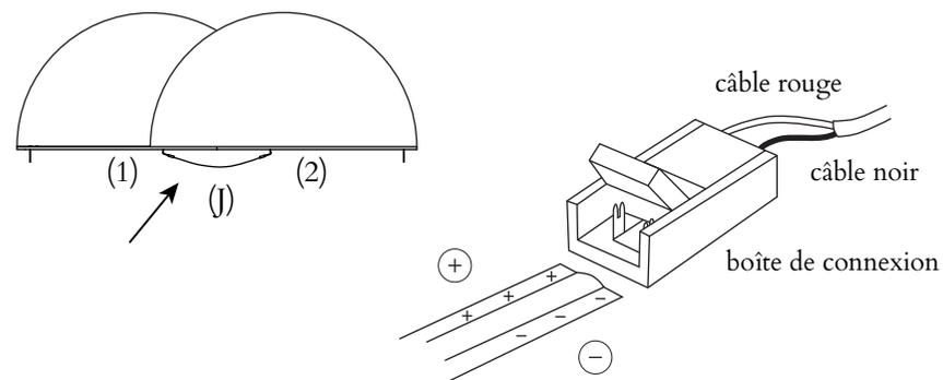
③ Vous avez reçu un câble de connexion pré-assemblé (K+L+M) qui vous permet de connecter les LED à la prise murale. Connectez l'extrémité de la bande LED de votre panneau arrière au début du câble (K) à l'aide de la boîte de connexion. Procédez de la même manière qu'à l'étape précédente.
