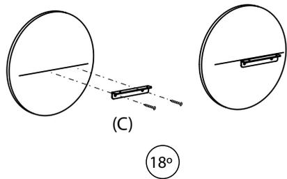
Atornille la pletina en L metálica usando la línea marcada
