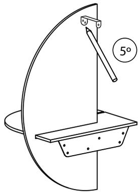
Coloque la pieza en "U" entre la pared y el panel trasero.
