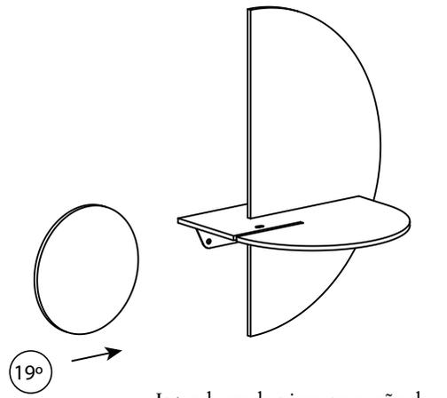
Introduzca la pieza pequeña de madera con la pieza metálica en la parte trasera
