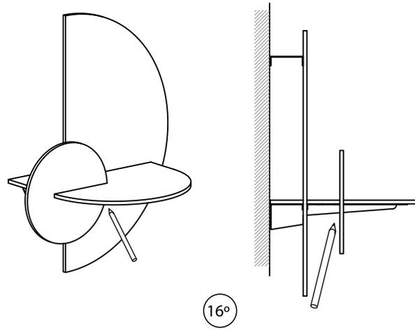
Haga una línea en la intersección de la pieza pequeña de madera por la parte trasera
