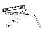
Utiliser l'outil de nivellement Marquer les trous avec un crayon
