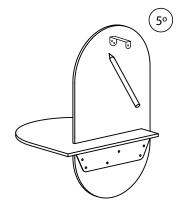
Coloque la pieza en "U" entre la pared y el panel trasero. Marque los tres orificios con un lápiz
