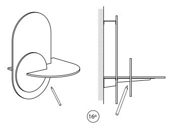
Haga una linea en la intersección de la pieza pequeña de madera por la parte trasera
