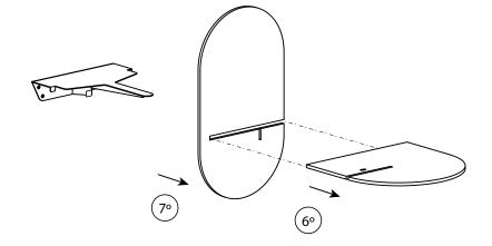
Atornille la pieza en "U" al panel trasero (x2 tornillos)
