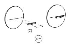
Atornille la pletina en L metálica usando la linea marcada
