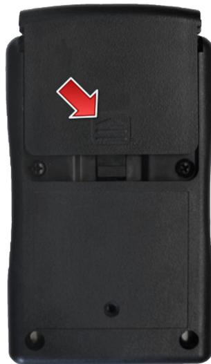
Abb. 3D Tacho - Batterien austauschen.
