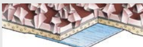
Gestossene Verbindung mit rückseitiger Spezialfolie
