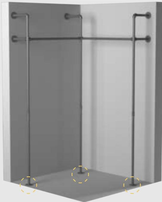
**Zum Schluss Stange "A fitting" ein wenig herausdrehen und gegen den Boden zu verspannen. Damit erhält man eine zusätzliche Stabilität und gleicht Unebenheiten im Boden aus./**
