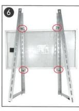
2.6 Schieben Sie die Endklemmen (4) nun fest an den Rahmen des Solarmoduls und schrauben die Sechskantschrauben (2) mit Hilfe des Maulschlüssel (8) fest, um die Halterungen (1) und das Solarmodul stabil zu verbinden.
