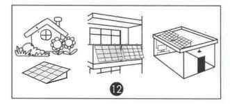
2.12 Die multifunktionale Halterung kann durch Ihre Konstruktion auch auf dem Boden oder einem (Flach-) Dach aufgestellt und befestigt werden.
