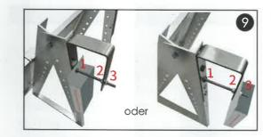
2.9 Befestigen Sie den Wechselrichter wie in Abbildung 9 gezeigt z.B. in der Mitte oder am Ende der langen Schrauben (6), je nachdem wo der Wechselrichter besser sicher befestigt werden kann.
