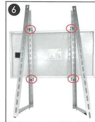
2.6 Schieben Sie die Endklemmen (4) nun fest an den Rahmen des Solarmoduls und schrauben die Sechskantschrauben (2) mit Hilfe des Maulschlüssels (8) fest, um die Halterungen (1) und das Solarmodul stabil zu verbinden.
