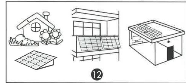
2.12 Die multifunktionale Halterung kann durch Ihre Konstruktion auch auf dem Boden oder einem (Flach-) Dach aufgestellt und befestigt werden. Mit den mitgelieferten Schrauben (3) können Sie die Halterung (1) z.B. an vorhandenen Befestigungsmöglichkeiten auf Dächern oder am Boden befestigen.
