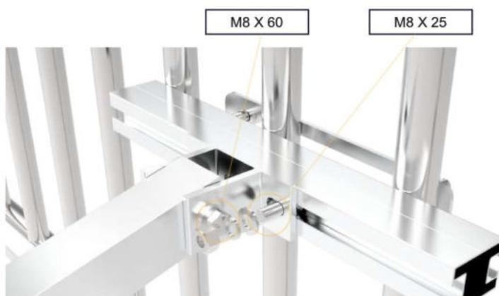
Die Teleskopstangen sind werkseitig vormontiert. Der jeweilige Sockel der Teleskopstange wird ebenfalls mit M8-Schrauben außen auf der Führungsschiene arretiert.
