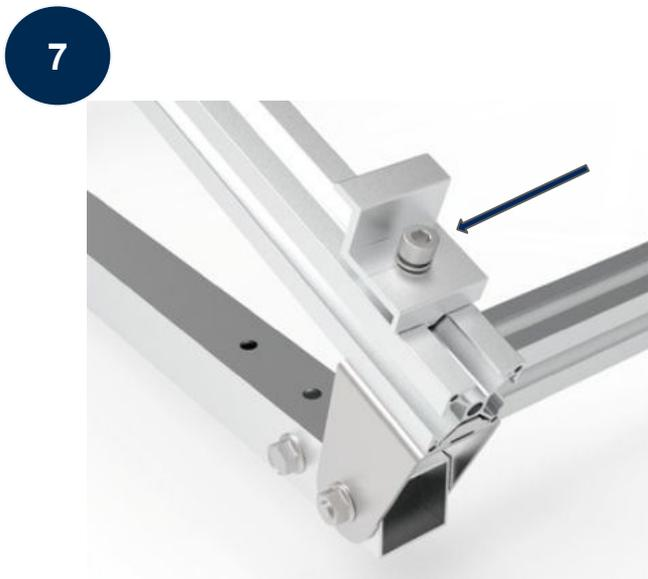
Befestige die beiden Endklemmen am unteren Teil des Rahmens. Beachte dabei die entsprechenden Vorbohrungen im Rahmen. Setze nur das Solarpanel auf die Endklemmen und ziehe diese dann fest, sodass der Rahmen des Panels fixiert wird.
