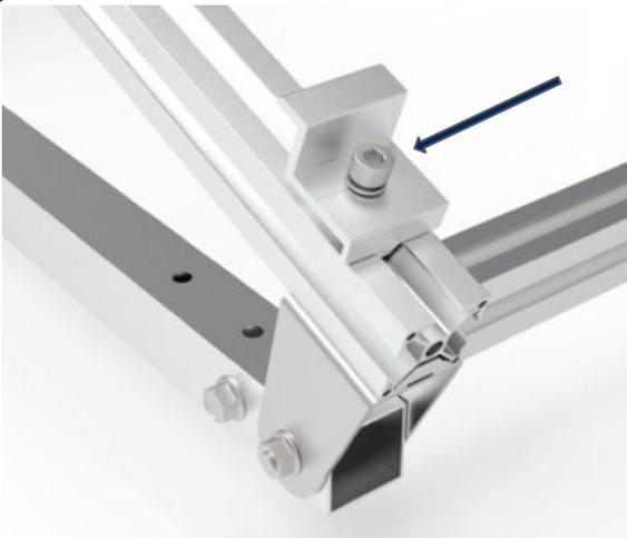
Befestige die beiden Endklemmen am unteren Teil des Rahmens. Beachte dabei die entsprechenden Vorbohrungen im Rahmen. Setze nur das Solarpanel auf die Endklemmen und ziehe diese dann fest, sodass der Rahmen des Panels fixiert wird.
