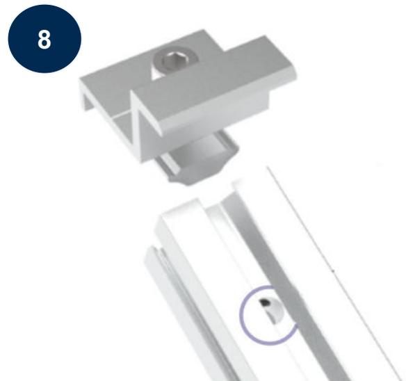
Befestige nun auch die Endklammern auf der Gegenseite, um das Solarpanel ordentlich und sicher an der Rahmenkonstruktion zu befestigen.
