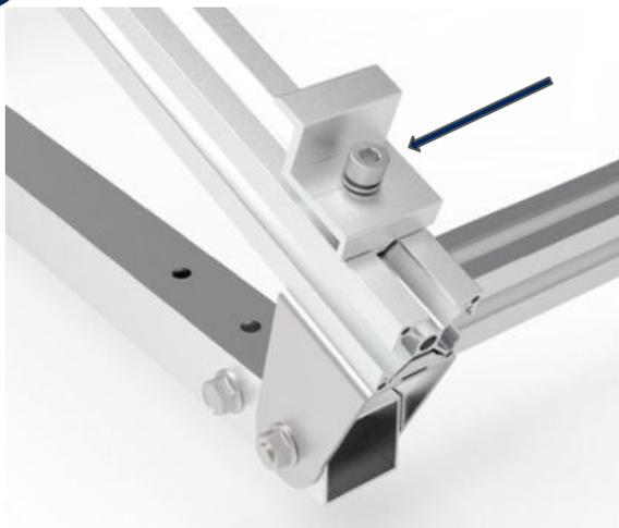
Befestige die beiden Endklammen am unteren Teil des Rahmens. Beachte dabei die entsprechenden Vorbohrungen im Rahmen. Setze nur das Solarpanel auf die Endklammen und ziehe diese dann fest, sodass der Rahmen des Panels fixiert wird.
