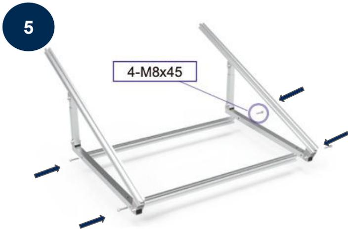
Verschraube mit 4-M8x45 nun beide Seitenteile mit den beiden Querstangen zu einem stabilen Rahmen.
