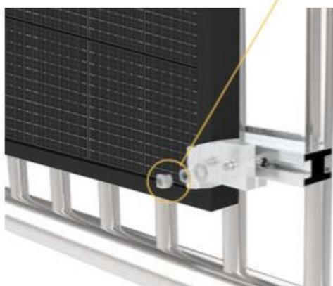
Verwende die beiliegenden Endklemmen, um das Solarpanel direkt an der Führungsschiene zu befestigen. Führe dazu die beiliegenden M8 Schrauben in die Nut der Führungsschiene und ziehe die Mutter außen sorgfältig fest.
