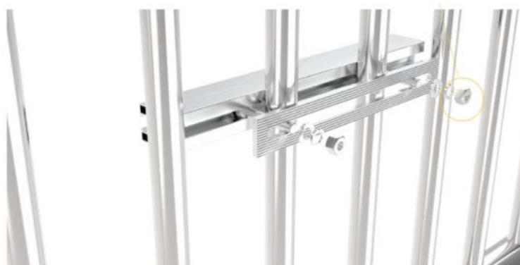
Setze die Schraubenköpfe der Aluminium-Platte in die Nut der Führungsschiene ein. Die Aluminium-Platte befindet sich nun auf der Innenseite des Geländers. Schraub sie fest, wie es auf dem Bild gezeigt ist.
