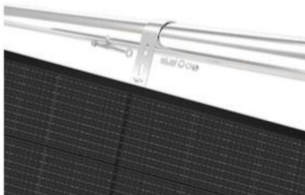
Sichere den Geländerhaken mit den M8x90 Schrauben und ziehe diese ordnungsgemäß fest. Der Bolzen garantiert, dass der Haken am Geländer gesichert wird.
