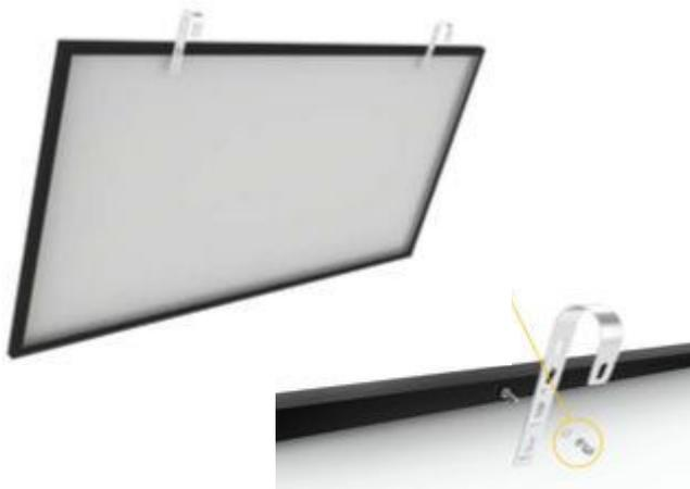
Befestige die beiden Geländerhaken mithilfe der beiliegenden Schraube an der vorgesehenen Stelle mit dem Solarpanel und hänge das Solarpanel auf dem Balkongeländer ein
