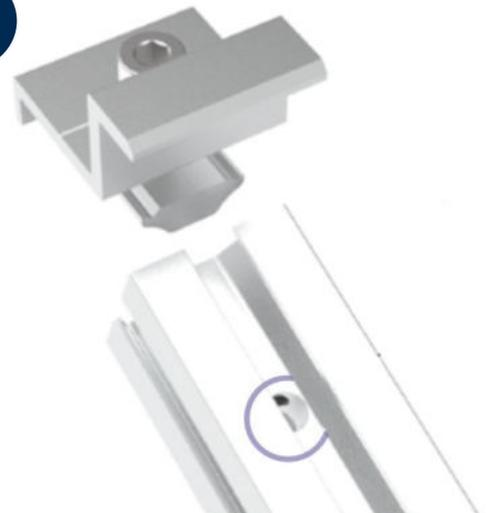
Befestige nun auch die Endklammern auf der Gegenseite, um das Solarpanel ordentlich und sicher an der Rahmenkonstruktion zu befestigen.
