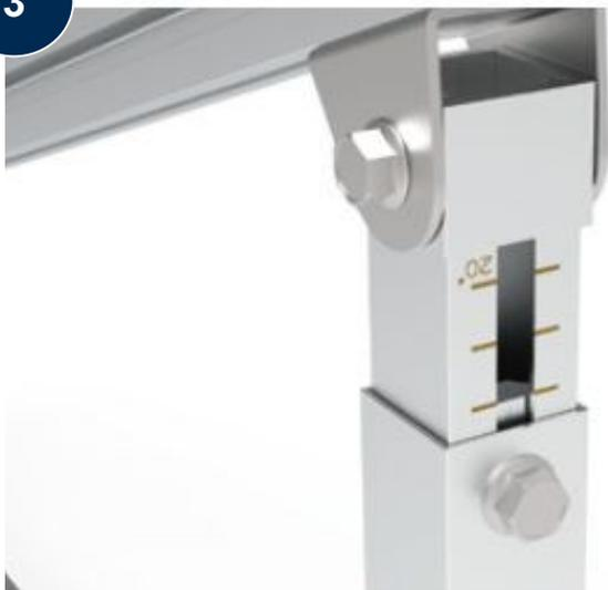
Stelle die Einstecktiefe ein und richte die Skala aus um den gewünschten Winkel zu bestimmen. Verriegle diesen im Anschluss mithilfe der vormontierten Sechskantschrauben.
