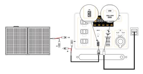
注:USB-Type-Cと組み合わせると充電時間が短縮できます。充電プロトコルに応じて、O~60Wの範囲の入力電力を増加させることができます。
