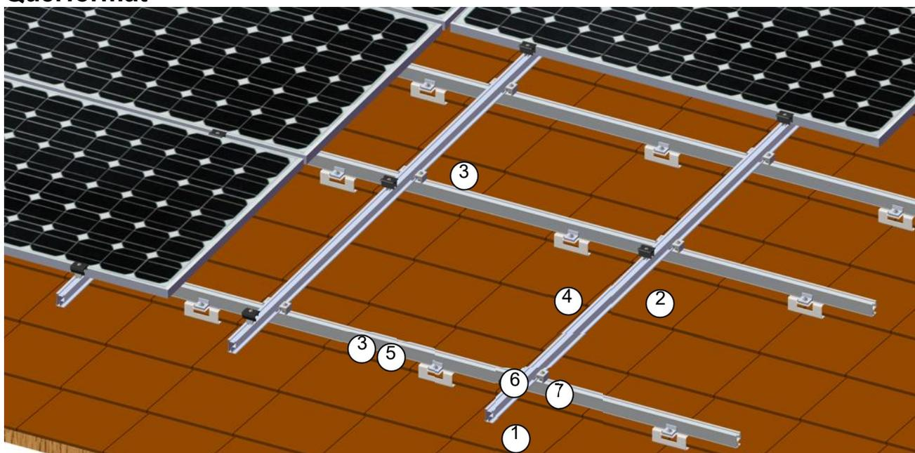
1) Endklemme 2) Zwischenklemme 3) DC Schiene 50 4) Ziegelschnittstelle
