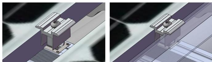
**EINMALIGEN GEBRAUCH** vorgesehen! Ziehen Sie die Schrauben erst fest an, wenn die Position des PV-Moduls endgültig festgelegt ist. (Ziehen Sie die Schrauben nur leicht an, um die PV-Module vor der Endkontrolle in Position zu halt
