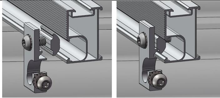
Das Erdungskabel kann auch über einen Kabelschuh an der oberen Schraube der Erdungsklemme mit 14 Nm angeschlossen werden, wie in den rechtsstehenden Abbildungen dargestellt. Der Kabelschuh sollte zwischen dem Schraubenkopf und der Zahnscheibe angebracht werden.
