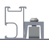
der DC-Schiene 50 ein, bewegen Sie den Kreuzverbinder 2.0 nah an die Schiene und befestigen Sie die M8 Torx-Schraube locker, wie in den rechtsstehenden Abbildungen dargestellt.
