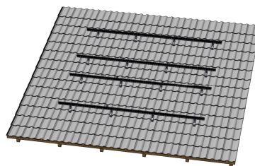
Die Schienen stehen senkrecht zum Sparren
