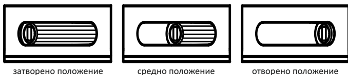
Фиг. 4. Пример за регулиране на въздушния поток към пещта (предна страна на
