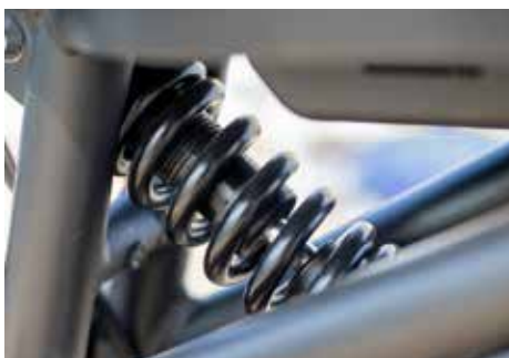
De schokdemper aan de achterzijde is instelbaar
