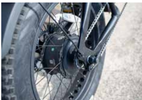
Yadea maakt gebruik van een eigen motor in het achterwiel
