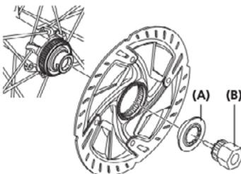
(A) Anel de trava do rotor do freio a disco
