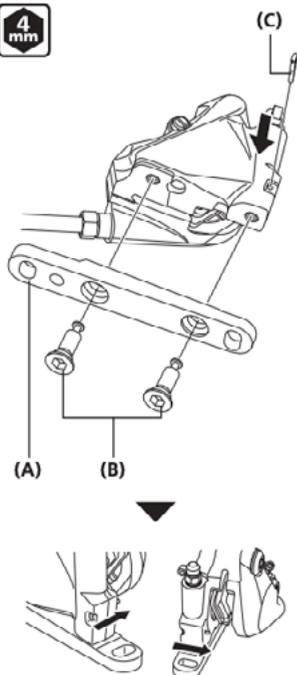
Instale o suporte de montagem na pinça de freio.
