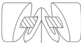
2. Certifique-se que a parte abaulada do expansor está corretamente direcionada ao perfil do canote, tendo-se então as partes côncavas e convexas face a face para a correta fixação do canote
