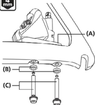
Use o parafuso de fixação da pinça de freio C e uma arruela para firmar o suporte ao quadro.
