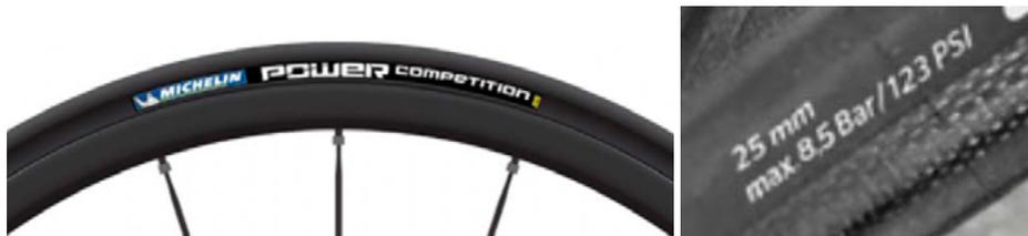
Verifique o encaixe correto a partir da linha de controlo dos pneus que passa por cima do aro. Esta linha deve dar a volta completa no pneu, mantendo-se sempre a mesma distância do aro .
