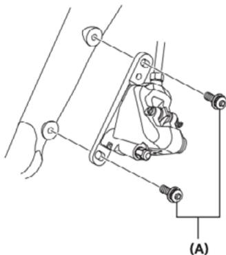
(A) Parafuso de montagem A da pinça de freio
