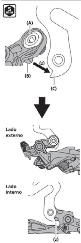
O diagrama ilustra o processo de ajuste do câmbio traseiro. No topo, uma seta indica a aplicação de uma chave Allen de 5 mm para apertar o parafuso de fixação (A). Abaixo, duas vistas mostram o ajuste do parafuso de regulagem do limite exterior (B) e do limite interior (I) em relação ao batente da extremidade do garfo (C). Uma seta (z) indica o ponto de contato. Uma seção inferior mostra o câmbio instalado no lado externo e interno, com a seta (z) indicando o ajuste.
