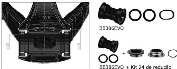
Para um melhor desempenho, instale um conjunto de pedivela com eixo de 30 mm. No entanto, você pode instalar eixos de 24 mm usando um redutor “BB386EVO 24”.
