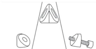
3. Aperte o parafuso de fixação na lateral do tubo do selim, com torque sugerido recomendado de 6 a 8 Nm. (fig. 3)
