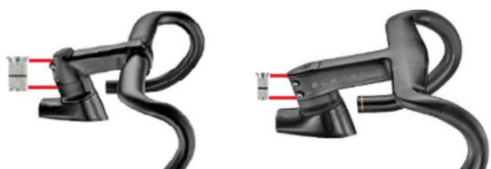
Com todos os espaçadores originais ou com a espiga cortada e menos espaçadores manter o compressor da altura do avanço para os parafusos de aperto do avanço estarem apertando o compressor por completo.
