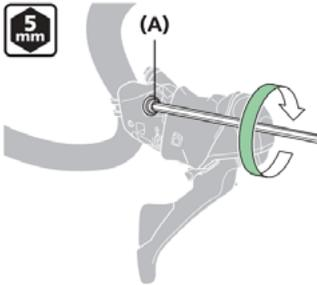
Use uma chave Allen de 5 mm para desapertar o parafuso de fixação na seção superior do suporte e, em seguida, aperte-o depois de posicioná-lo no guidão.
