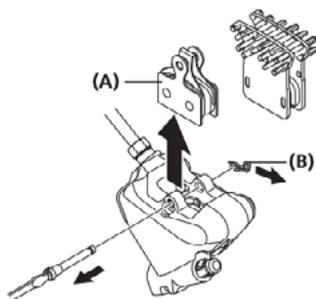
Remova a roda do quadro e, em seguida, as pastilhas de freio conforme mostrado na ilustração.
