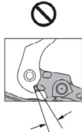
O diagrama de alerta mostra um símbolo de proibição (um círculo com uma barra diagonal) sobre uma imagem que ilustra uma abertura indesejada entre o batente do garfo e a projeção do suporte. Duas setas apontam para esta abertura.
