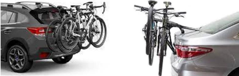
**ATENÇÃO:** *Cuidado neste tipo de rack com a proximidade do escapamento com as rodas e pneus que podem deformar devido aos gases quentes*
