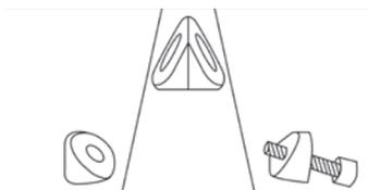
4. Aperte o parafuso de fixação na lateral do tubo do selim, com torque sugerido recomendado de 6 a 8 Nm. (fig. 3)
