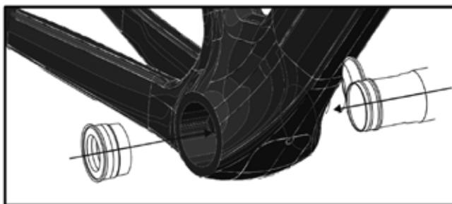
Siga as instruções do conjunto de pedivela. Se você não tem as ferramentas de instalação adequadas, aconselhamos que você vá até uma revenda da Swift para instalar o BB. Um conjunto de rolamentos corretamente instalado economizará significativamente os custos de manutenção.
