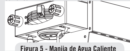
Figura 5 - Manija de Agua Caliente
