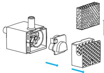
2. Entfernen Sie das Laufrad am Bürstenhaken.
