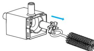
3. Reinigen sie die Teile mit der Bürste und Wasser.
