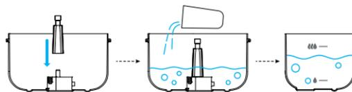
4. Installieren Sie die Wasserschale und befestigen Sie die Deckel.
