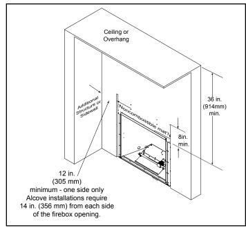
Figure 3.4. Clearances to Combustibles
